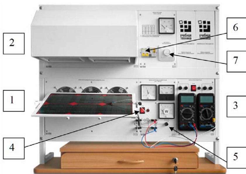
Рис.5.8. Общий вид лабораторного стенда: 1- солнечная батарея; 2 - источник излучения; 3 - блок управления и контроля (остальные обозначения в тексте).
