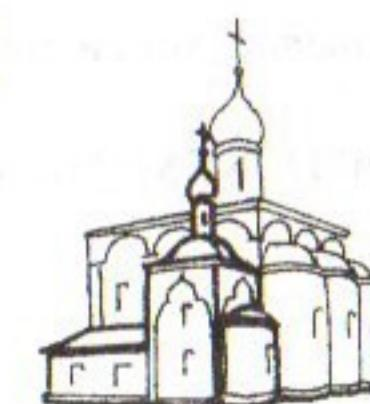
**ПРИРУБ** – небольшая деревянная пристройка, конструктивно связанная с основной частью здания.
