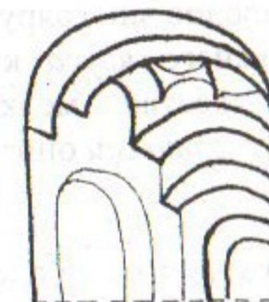
**СТУПЕНЧАТЫЙ ТРОМП** – тромп в виде двух или более арок, расположенных одна под другой.
