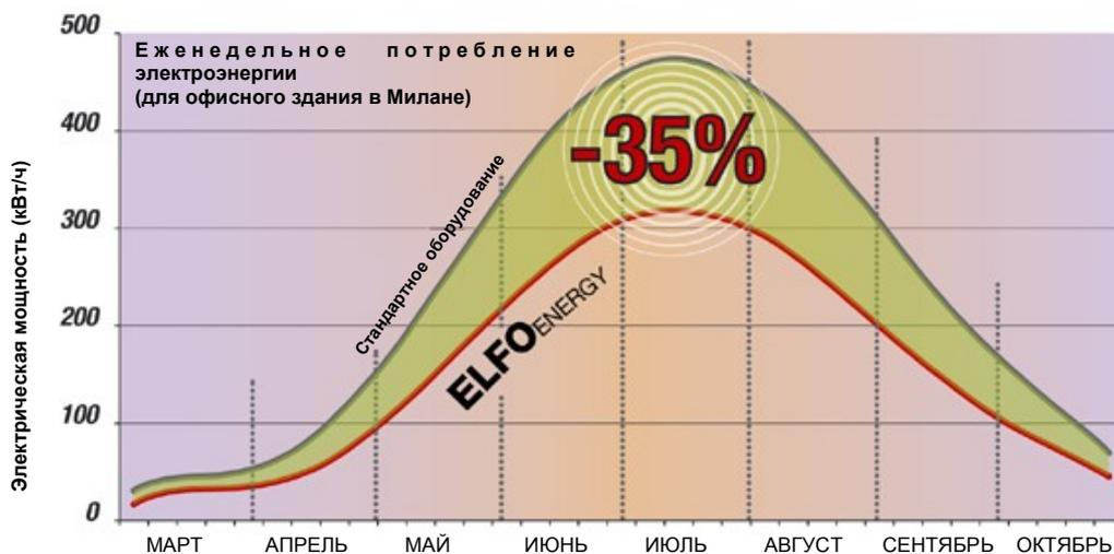
В системе с блоком мощностью 34 кВт, годовая экономия электроэнергии при использовании ELFOENERGY составляет порядка 3000 кВт/ч, что соответствует 500 евро и снижению потребляемого топлива для транспортировки и сгорания - 590 кг.
