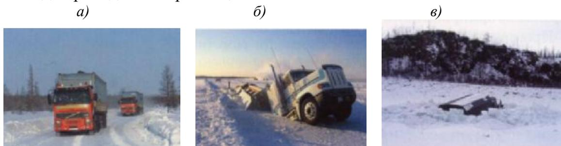
Рис. 6. Отечественный опыт использования неармированного льда, в качестве ледовых переправ или автозимников через сибирские реки, озера и болота: а – автозимник для большегрузных автомобилей; б, в – примеры аварийных ситуаций на ледовых переправах или автозимниках
