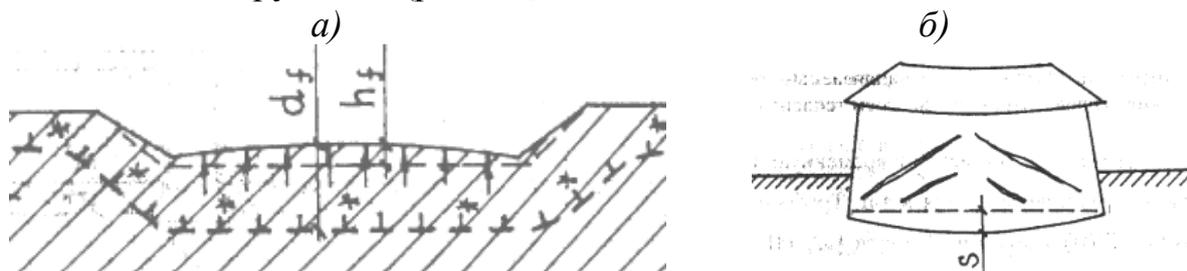
Рис. 44. Принципиальные схемы деформаций неравномерно выпучиваемого мерзлого грунта основания (а) и формирования наклонных трещин в конструкциях надземного остова (б) в результате неравномерных поднятий и опусканий фундаментов, вызванных морозным пучением
