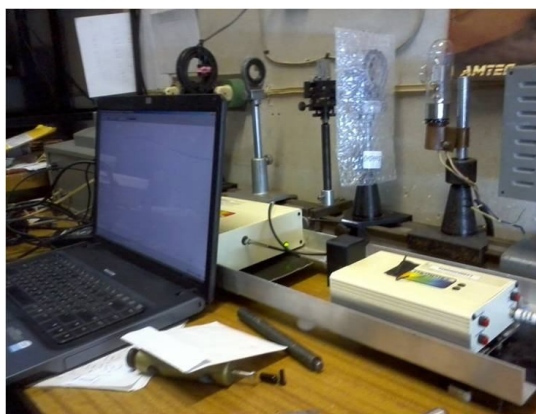
Рис. 7. Установка по измерению УФ радиации
