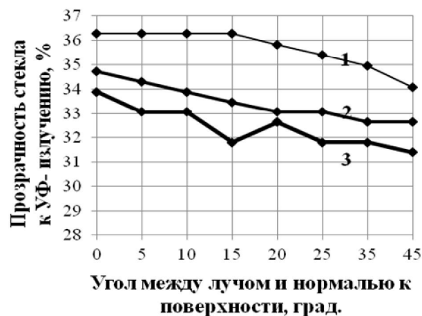
Рис. 12. Зависимость прозрачности стекол Stopsol Supersilver Clear в УФ (В+С) диапазоне от величины угла падения луча: 1–толщиной 4 мм; 2–толщиной 6 мм; 3–толщиной 8 мм
