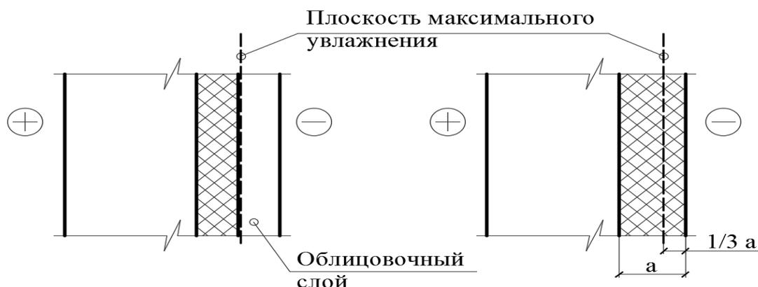
Рис. 2. Определение плоскости максимального увлажнения
