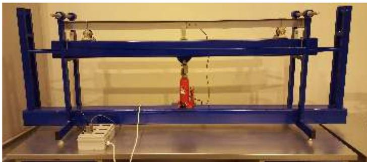
Учебный стенд предназначен для проведения лабораторных работ по изучению статической устойчивости изгибаемого стержня в рамках дисциплин «Сопротивление материалов» и «Металлические конструкции» группой из 2–4 человек. Стенд представляет собой силовую раму с
