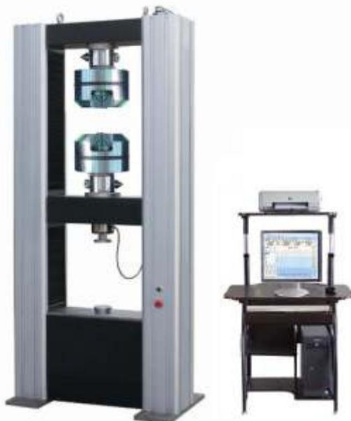
Универсальные испытательные машины серии ИР 5082 предназначены для определения механических свойств различных образцов конструкционных материалов (металлы, сплавы, пластмассы, резины и др.) и изделий (пружины, трубы и т.п.) при испытаниях на растяжение, сжатие, изгиб и др., в пределах технических возможностей машины. Машины серии ИР 5082 обеспечивают регистрацию изменения нагрузки и удлинения и выдачу информации о результатах на дисплей компьютера (ПК) для дальнейшей обработки.
