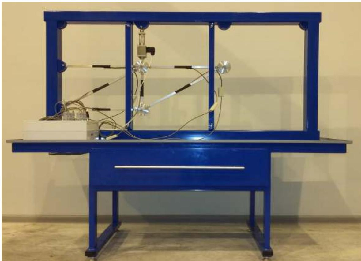
Стенд учебный «Колебания ферменных конструкций» предназначен для проведения лабораторных работ группой из 2-4 человек.
