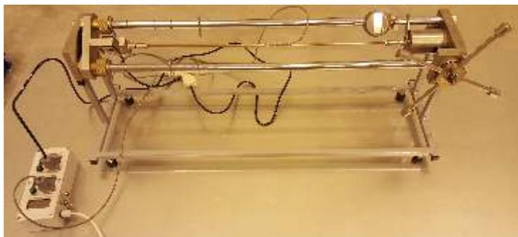
Стенд позволяет задавать и определять перемещение подвижной нагружающей опоры и усилие, передаваемое на образец. Стенд позволяет проводить испытание на сжатие образцов, входящих в комплект, до потери устойчивости. На образцах установлены тензорезисторы для определения факта потери
