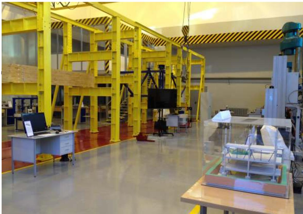
**Универсальный испытательный стенд предназначен для экспериментальных исследований строительных конструкций различных пролетов (до 24м) и высот (до 4м).**
