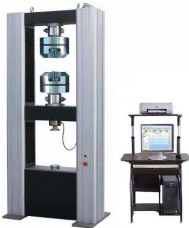
Универсальные испытательные машины серии ИР 5082 предназначены для определения механических свойств различных образцов конструкционных материалов (металлы, сплавы, пластмассы, резины и др.) и изделий (пружины, трубы и т. п.) при испытаниях на растяжение, сжатие, изгиб и др. Машина серии ИР 5082 обеспечивает регистрацию изменения нагрузки, удлинения и выдачу информации о результатах испытаний на дисплей компьютера, для дальнейшей обработки.
