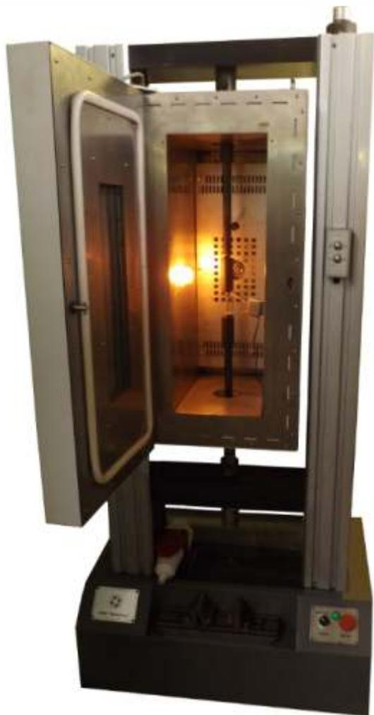
*Система температурных испытаний (термосистема) СТИ-1 предназначена для испытаний образцов из различных материалов при повышенных и пониженных температурах на разрывных машинах.*
