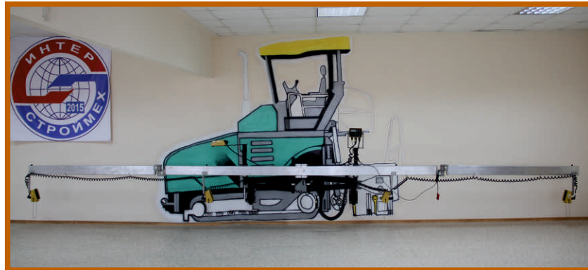
Лабораторный стенд «Система нивелирования асфальтоукладчика»
