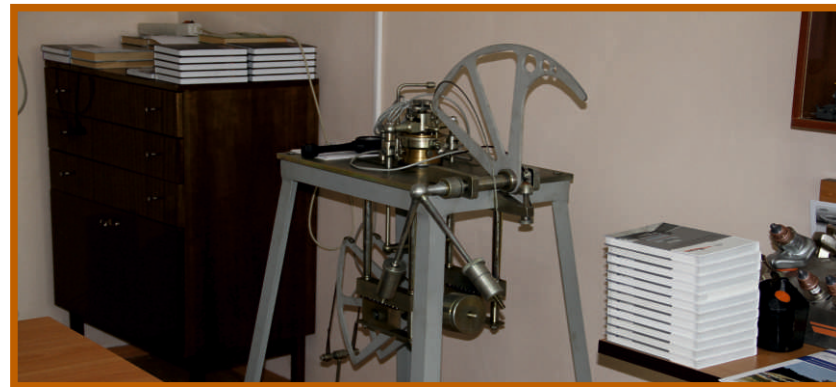
Прибор для испытания грунтов на сдвиг ПСГ-3М
