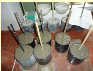
Исследование совместной работы полимеркомпозитной арматуры в бетонных конструкциях
