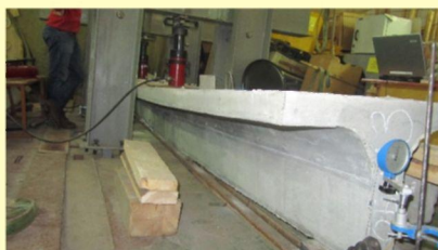
Динамические и статические испытания бетонных балок пролетного строения моста с полимеркомпозитной арматурой
