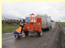
Мониторинг экспериментальных участков установкой Дина-3М
