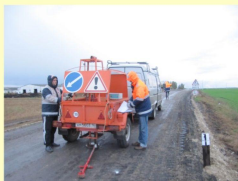
Измерение модуля упругости на экспериментальных участках дороги установкой ДИНА-3М
