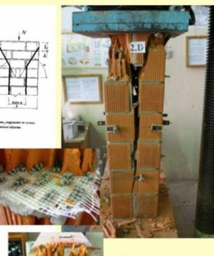
Испытания каменных кладок из пустотных поризованных камней
